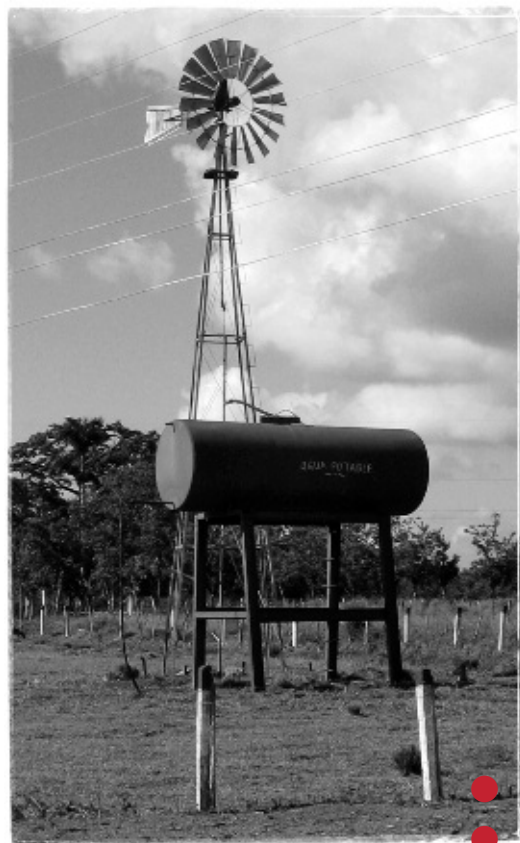
Die Windmühle treibt die Pumpe für das Frischwasser an, damit die Ziegen der Genossenschaft in Pinar del Río regelmäßig versorgt werden.
